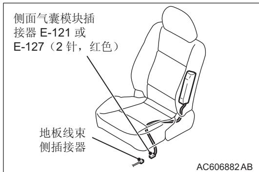
**应将驾驶员侧和乘客侧的侧面气囊模块都膨开。**
